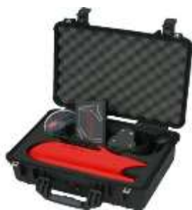
локатор за страничен обзор StarFish 452F на фирмата Tritech
